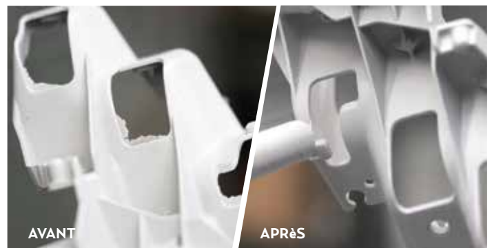
Gros plan d'une pièce moulée avec retrait de l'excédent de bavure
