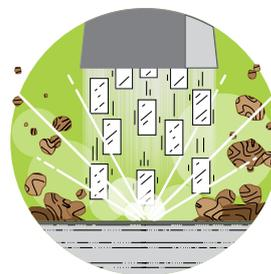
SOBALD DAS TROCKENEIS MIT DER OBERFLÄCHE KOLLIDIERT, SUBLIMIERT ES - WAS EINE MIKRO CO<sub>2</sub>-EXPLOSION VERURSACHT, DIE DIE VERSCHMUTZUNG ENTFERNT.
